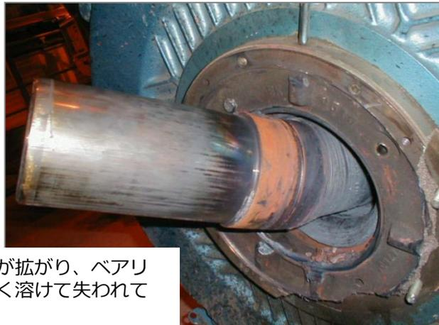
シャフトの軸受座が拡がり、ベアリングの部品も大きく溶けて失われています。
