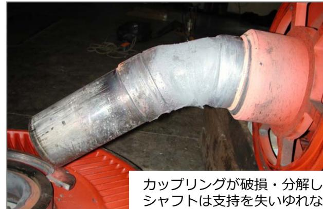
カップリングが破損・分解したため、シャフトは支持を失いゆれながら回転。緊急停止するとシャフトは床面まで垂れ下がり、その状態のまま固まりました。
