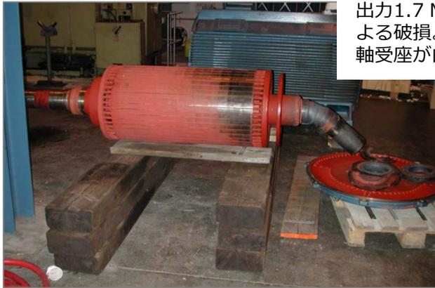
出力1.7 MWのモーター。ローターとステーターの接触による破損。【原因】駆動側ベアリングの注油不足により、軸受座が白熱するまで高熱を発して回転しました。
